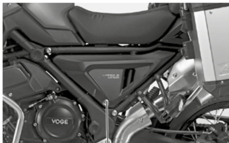
Serratura vano presa a 12V
